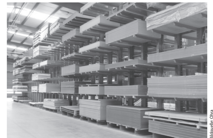
Ohra installierte bei Maderas Besteiro mehrere Paletten- und Kragarmregale
