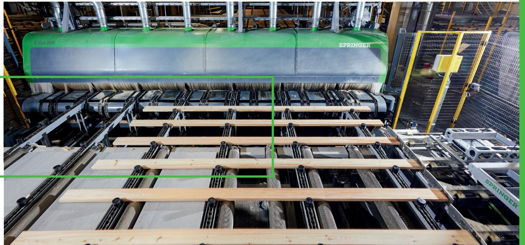
Der riemenlose Trimmer E-CUT 200 von SPRINGER besticht durch eine exakte Schnittführung und einen störungsarmen und kostenschonenden Betrieb.
